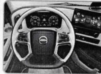
■ غربلگ فرمان مجهز به کلیدهای دسترسی به مولتی مدیا و کروز کنترل
