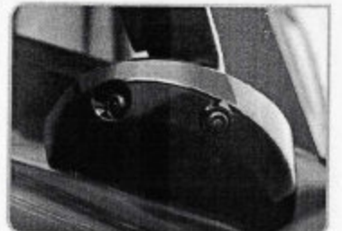
■ دوربین ۳۶۰ درجه به همراه سیستم رادار تشخیص نقاط کور (BSD)
